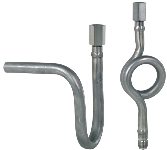
Sifone, DIN 16282, acciaio inox Fig. a sinistra: forma a U, forma B Fig. a destra: forma a ricciolo
