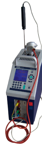
CTD9300 applicazione con sonda di riferimento esterna
